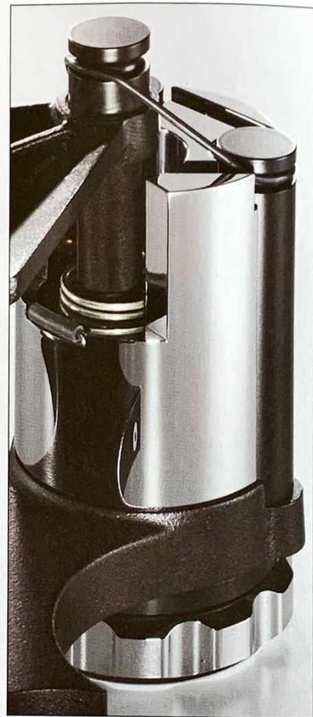
Solide Basis: An drei solchen Türmen ist das Subchassis an vertikalen Zugfedern eingehängt. Horizontale Gummiringe stabilisieren.
