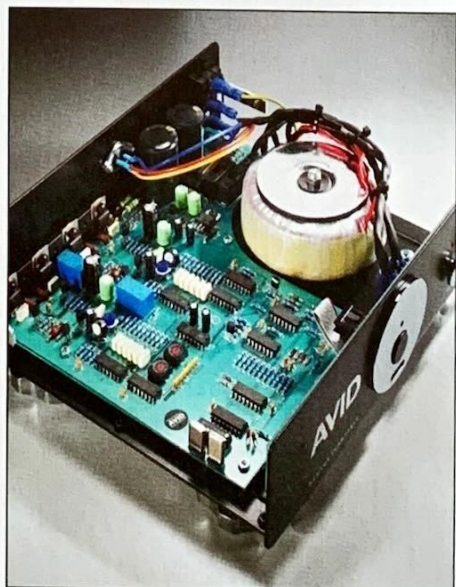
Chambre séparée: Das ausgelagerte Netzteil könnte einen ausgewachsenen Verstärker versorgen. Es schaltet und hält den Speed.
